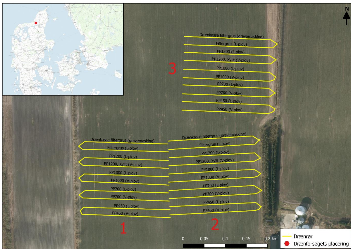
Figur 1: Drænkort over forsøgsarealet i Birkelse, Nordjylland. For hver gentagelse afprøves forskellige åbenheder i filteret omkring drænrøret samt forskellige dræningsmetoder. Forsøgsplan: Led 1: PP450 (V-plov), Led 2: PP450 (L-plov), Led 3: PP700 (V-plov), Led 4: PP700 (L-plov), Led 5: PP1000 (V-plov), Led 6: PP1000 (L-plov), Led 7: PP1200, Xylit (V-plov), Led 8: PP1200 (L-plov), Led 9: Nøgne rør pløjet ned med filtergrus (L-plov), Led 10: Nøgne rør gravet ned med gravemaskine og filtergrus.
